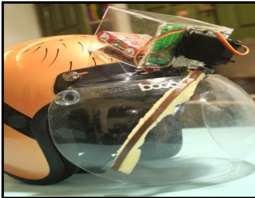
Gambar.14 Motor servo menggerakkan wiper kekiri dan ke kanan
