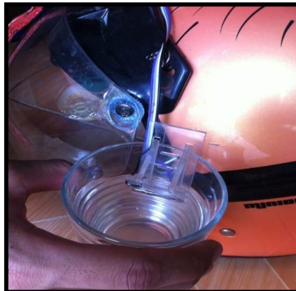
Gambar. 13 Sensor Hujan di Masukkan ke Dalam Air
