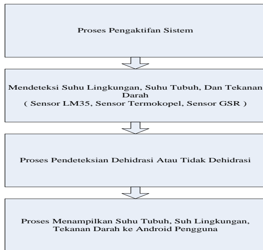
Gambar 3.1 Tahapan Sistem Alat deteksi dehidrasi pada manusia
