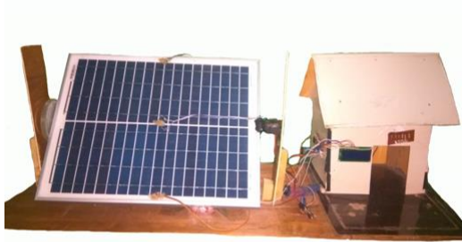
Gambar 3.7 Rancangan Sistem Smart Home Dengan Colar Cell
